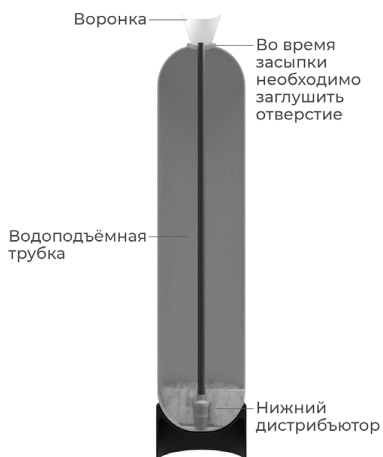
Заполнение фильтра материалом
