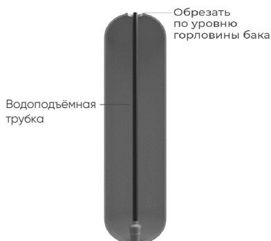
Обрезка водоподъемной трубы
